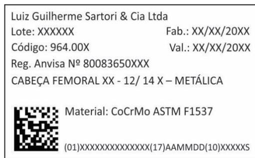
Figura 2 - Modelos de etiqueta de rastreabilidade do Sistema S-HIP Híbrido Metal - Cross Link
