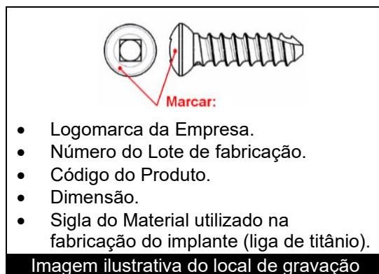
Figura 4 – Imagem ilustrativa do local de marcação a laser nos Parafusos para Microfragmentos
