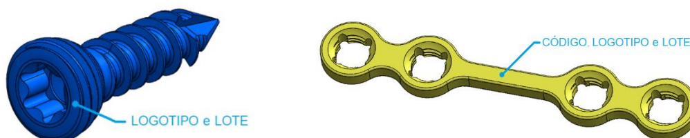
Figura 4 – Imagem ilustrativa dos locais de marcação à laser
