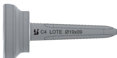
Figura 5 – Imagem ilustrativa do local de marcação a laser na Prótese Parcial para Cabeça de Rádio
